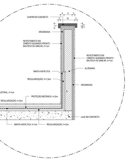
10 DETALHE GUARDA CORPO EM ALVENARIA E IMPERMEABILIZAÇÃO LAJE
